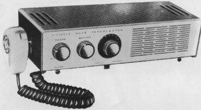
Guardate un po' come si possa realizzare il classico «cinque watt» con una sola valvola doppia 6AU8 preceduta da un modulatore costituito da una 6AN8 e una 6AQ5. Vale la pena di provarci, costa anche poco. Comunque state pur certi che quel vecchio aggeggio modulava molto bene e non c'era troppo da preoccuparsi per il ROS della linea d'antenna.
